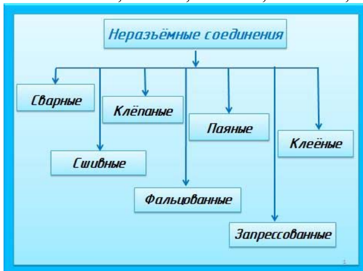
Рис. 114. Основные виды неразъемных соединений
